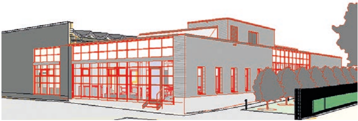
Abbildung 1: Ansicht Revit mit Bauphasen Bestand/Abbruch/Neu
